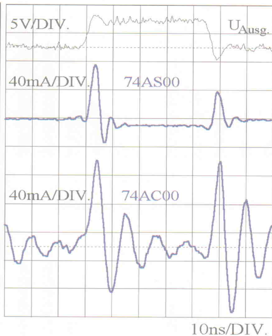
Bild 5. Vergleich der Schaltströme von CMOS und TTL.
